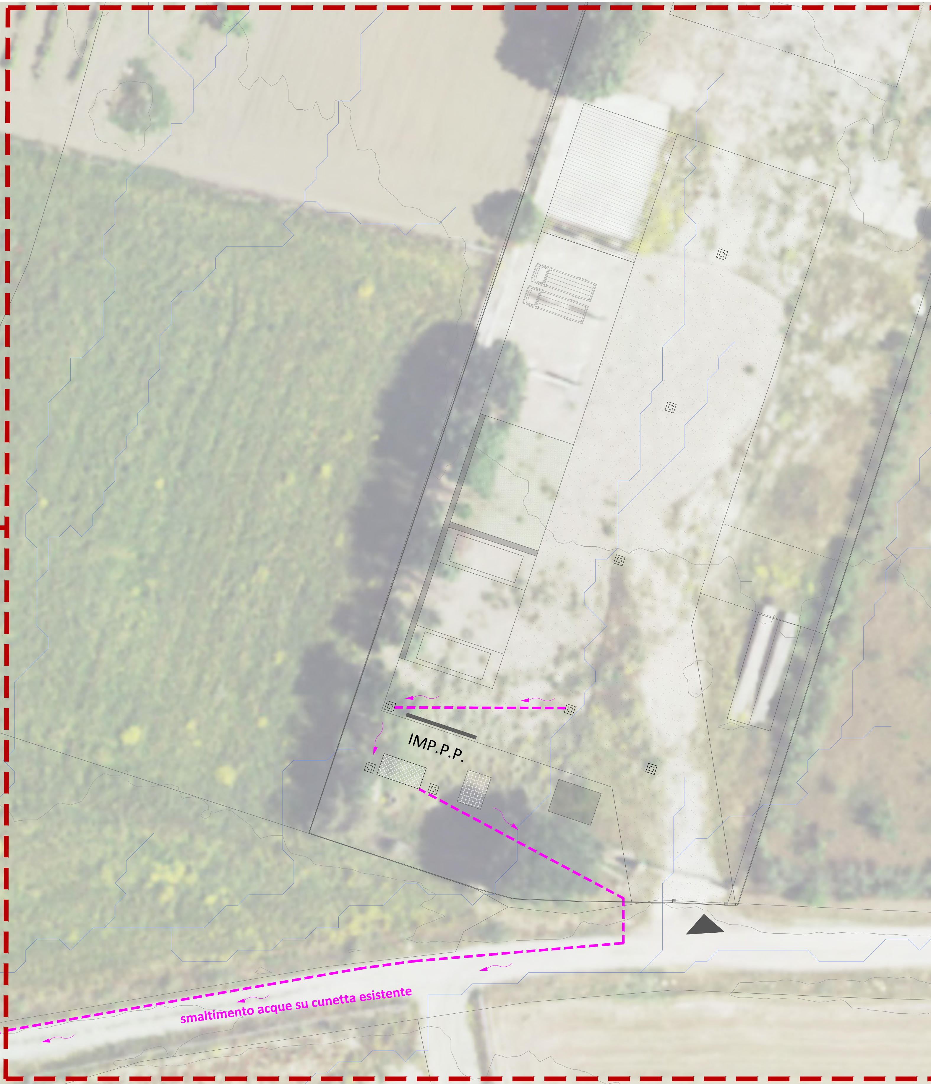
dettaglio flusso acque meteoriche impianto di messa in riserva_1:200
