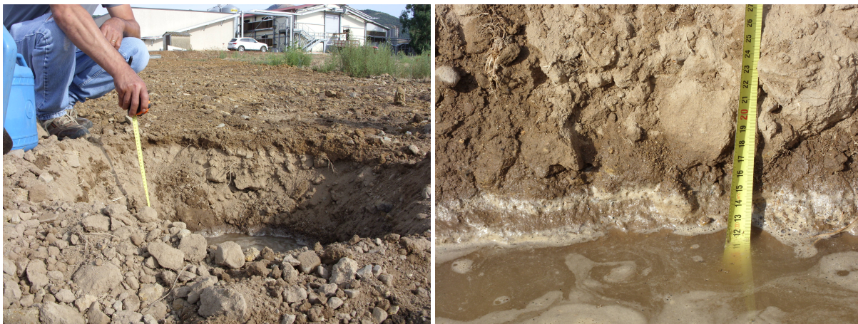
Fig. 7: Prova di permeabilità "in situ": una volta saturato il terreno è stato misurato il tempo necessario ad un abbassamento di 2 cm del livello d'acqua nel pozzetto, pari a 330 sec.
