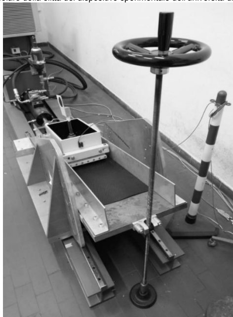
Figura 20 Particolare del sistema di variazione dell'inclinazione.
